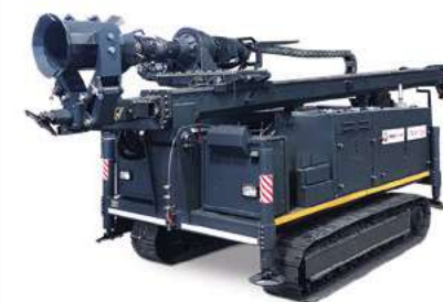
УГБ-900 СМОНТИРОВАНА НА ГУСЕНИЧНУЮ ТЕЛЕЖКУ С ПРИВОДОМ ГИДРОСИСТЕМЫ ОТ ДИЗЕЛЬНОГО ДВИГАТЕЛЯ ЯМЗ.
