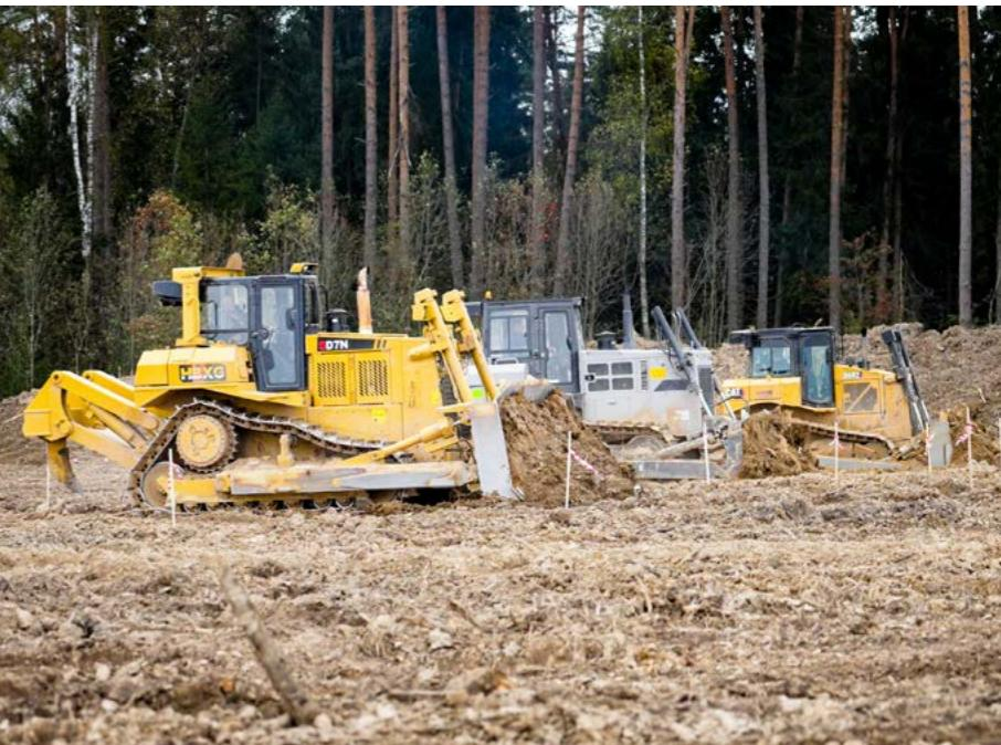
составила 136,8 куб.м, что на 23% выше, чем у модели №3 (105,5 куб.м), удельный расход топлива составил 0,346 л/куб.м, то есть на 12% меньше (у модели №3 — 0,386 л/куб.м). Стоимость одного кубического метра породы, перемещенной бульдозером HBXG SD7N, на 11,5% ниже, чем стоимость такого же объема породы, перемещенной моделью №3.
