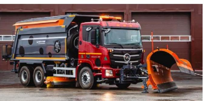
«Меркатор» (калужский завод компании входит в Ассоциацию «Росспецмаш») представил новинку — комбинированную дорожную машину 700АВГ на шасси Валдай 33 с зимним комплектом оборудования.
