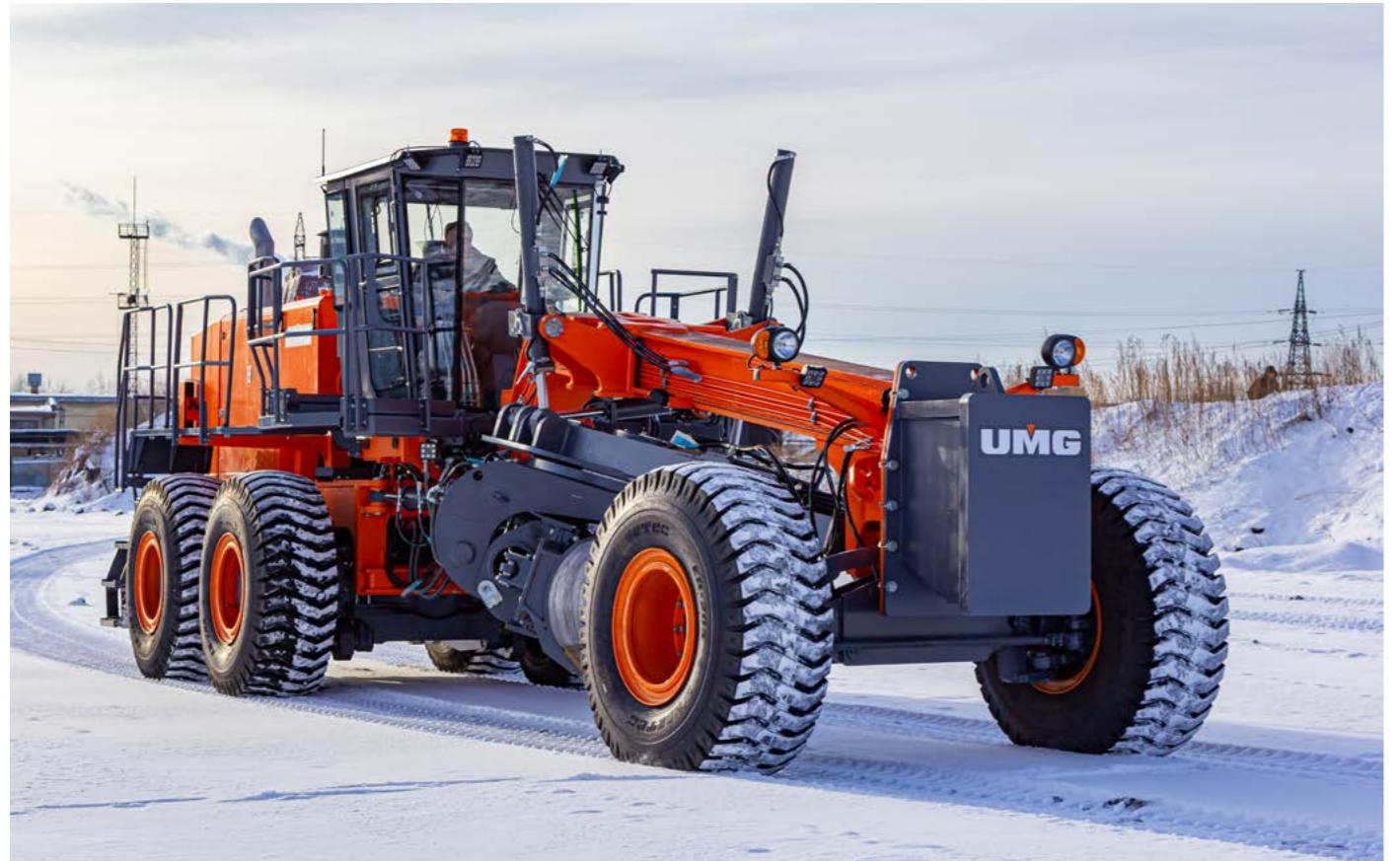
Автогрейдер оснащен двигателем ЯМЗ 7726 мощностью 309 кВт, машина комплектуется отвалами размером от 4,9 до 5,5 метров. Д3-350 имеет сочлененную раму, систему наклона колеса переднего моста, а также обладает возможностью «крабового хода», что делает его высокоеффективным при работе на карьерных месторождениях.
