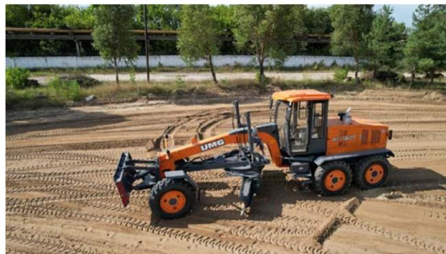
Компания UMG (входит в Ассоциацию «Росспецмаш») планирует до конца 2024 года завершить заводские испытания нового поколения грейдеров с гидромеханической трансмиссией, сравнимой с автоматической коробкой передач в автомобиле.
